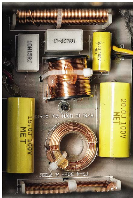
Zwrotnica SP 10. Liczba elementów LC (trzy cewki, trzy kondensatory), bez analizy połączeń, wskazuje na układ dwóch filtrów 3. rzędu (ale wraz z charakterystykami samych przetworników prawdopodobnie powstają zбочa akustyczne 4. rzędu).
